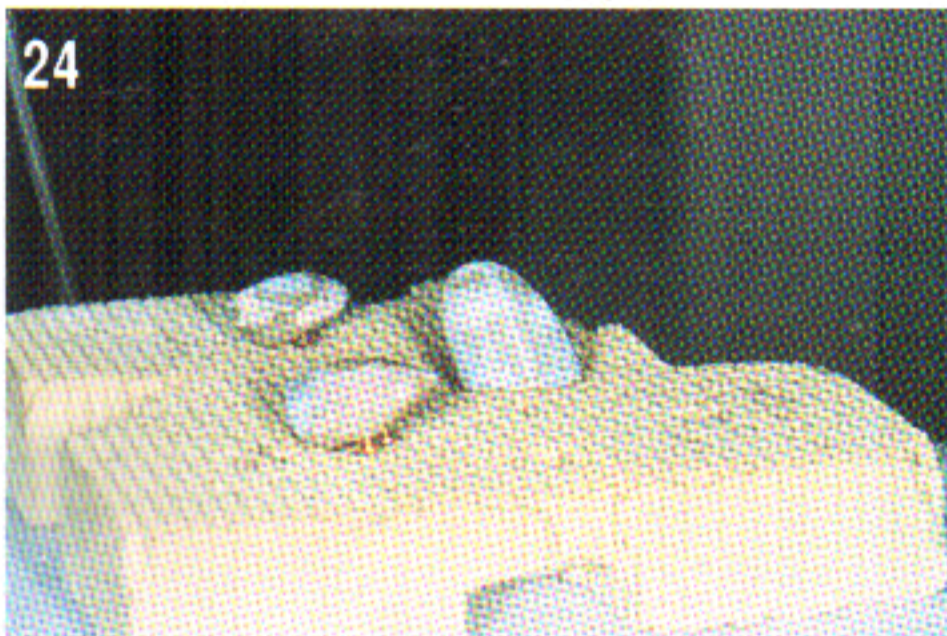
Figg. 24-25: Cottura in forno e glasatura. Fig. 26: Elementi caratterizzati a confronto con gli altri componenti della stessa serie reperibili in commercio.
