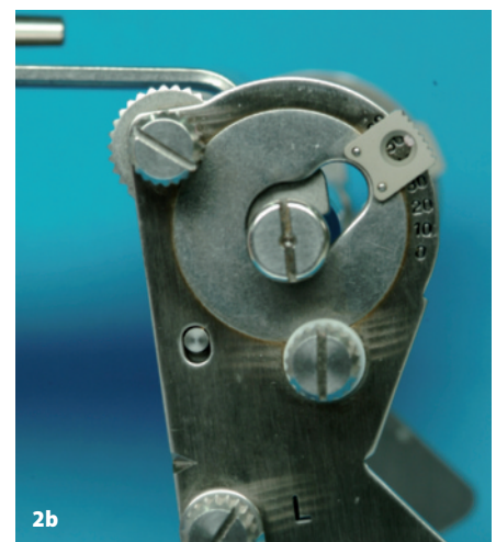
2 a-b. Le sicure condilari sono premute verso il basso e bloccate dalle apposite viti, fissando così i corpi articolari nella posizione di centrica. Questa è la posizione base per la messa in articolatore dei modelli, per tutti i lavori tecnici senza il controllo dei movimenti e per il molaggio dell'occlusione centrica.
